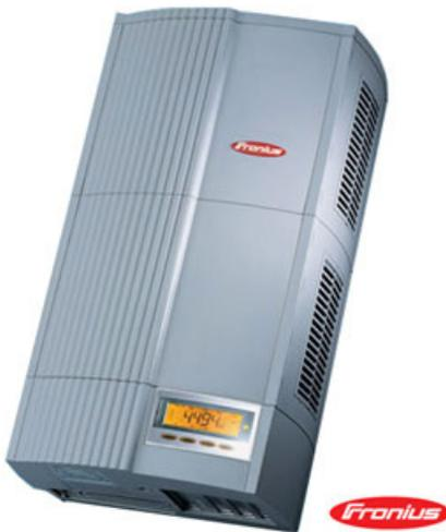
Leistungsstarker Wechselrichter mit HF-Transformator, hoher Ertrag durch 2 Leistungsteile im Mix-Konzept, dem optimierten Master Slave-System, mit Display, MPP-Spannungsbereich 150 bis 400 V, empf. PV-Anlagenleistung 3500 bis 5500 Wp, AC-Nennleistung 3500 W, max. Wirkungsgrad 94,3%, Gewicht 16 kg, 5 Jahre Garantie, - mit DC- u. AC-Klemme. IG 60 siehe Datenblatt
